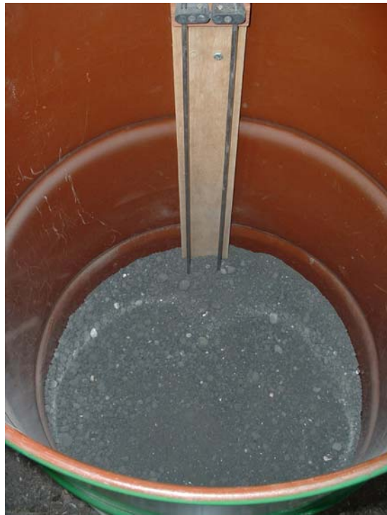
Figura A.3. 1 Línea de transmisión y clinker
