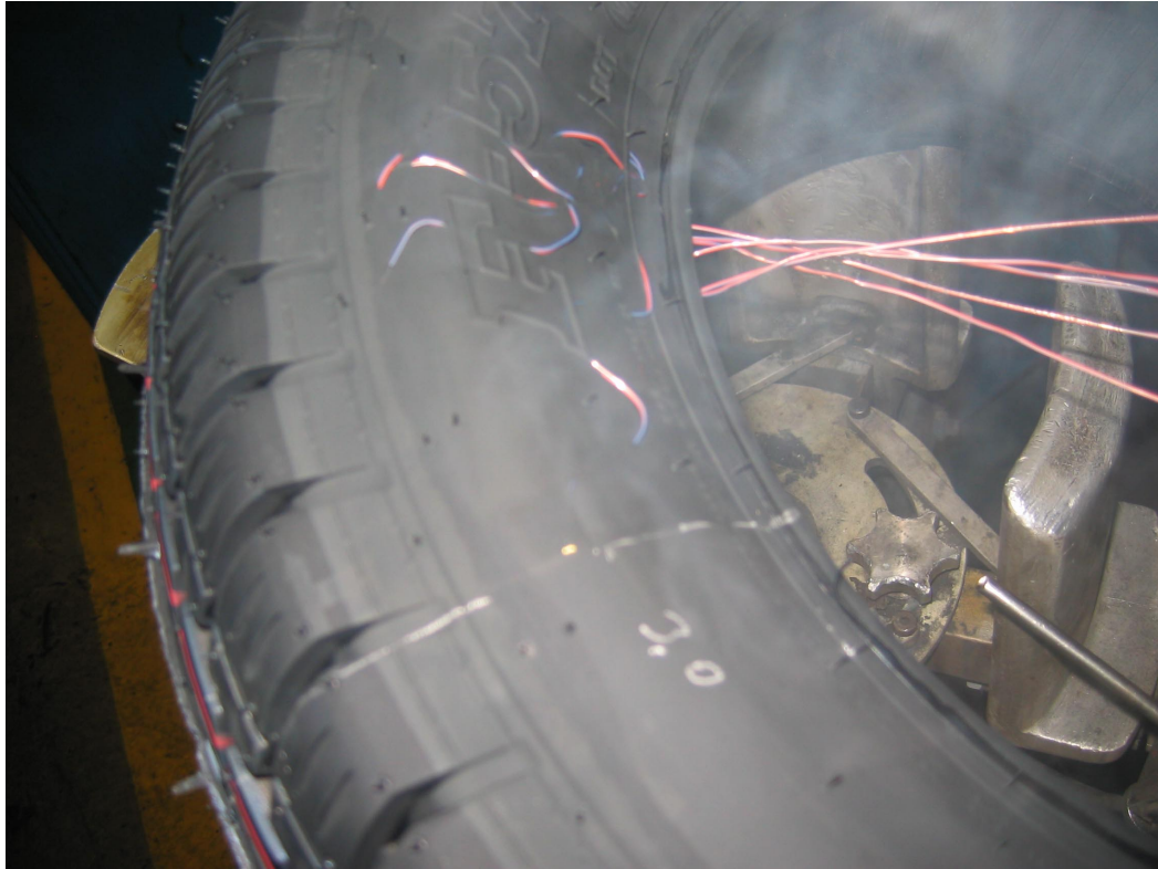
Figura 4.8 Termocuplas adheridas a la llanta luego del vulcanizado
