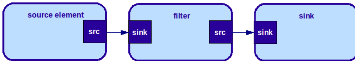
Figura 3.21: Estructura básica de un pipeline
