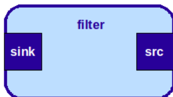
Figura 3.19: Visualización del elemento de Gstreamer: filtro
