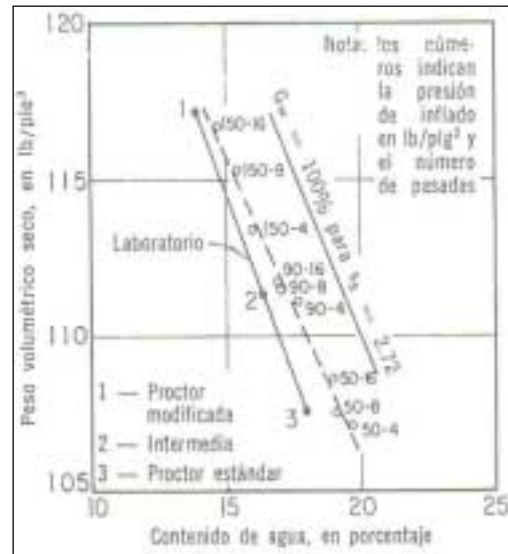
Figura 18. Comparación de líneas de óptimos de campo (rodillo neumático) y de laboratorio (Proctor), HBR, 1960.
