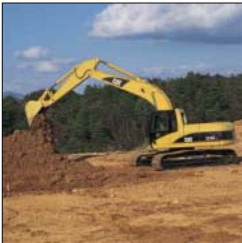
Excavadora hidráulica 320C L
