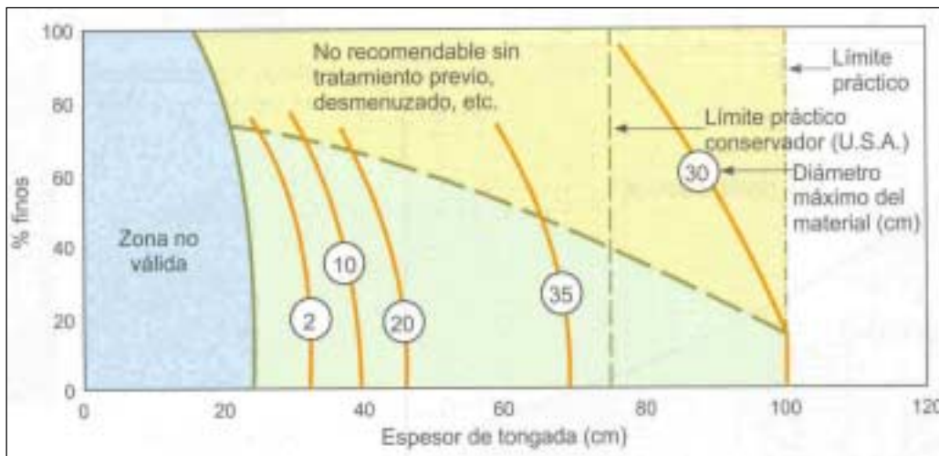
Figura 15. Recomendaciones para estimar el espesor de tongada (Oteo, 1998).
