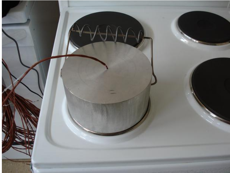
Figura 8.13 Colocación del termopar sobre el bloque de prueba.
