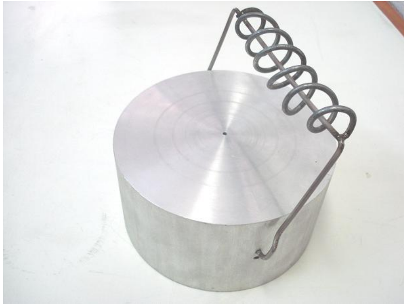
Figura 4.10 Ilustración del bloque de prueba construido.
