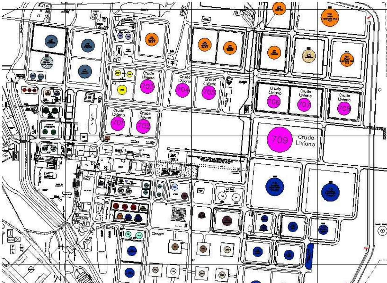
Figura 4. Distribución actual de los tanques de alimentación a planta y recepción importaciones de crudo liviano [2].
