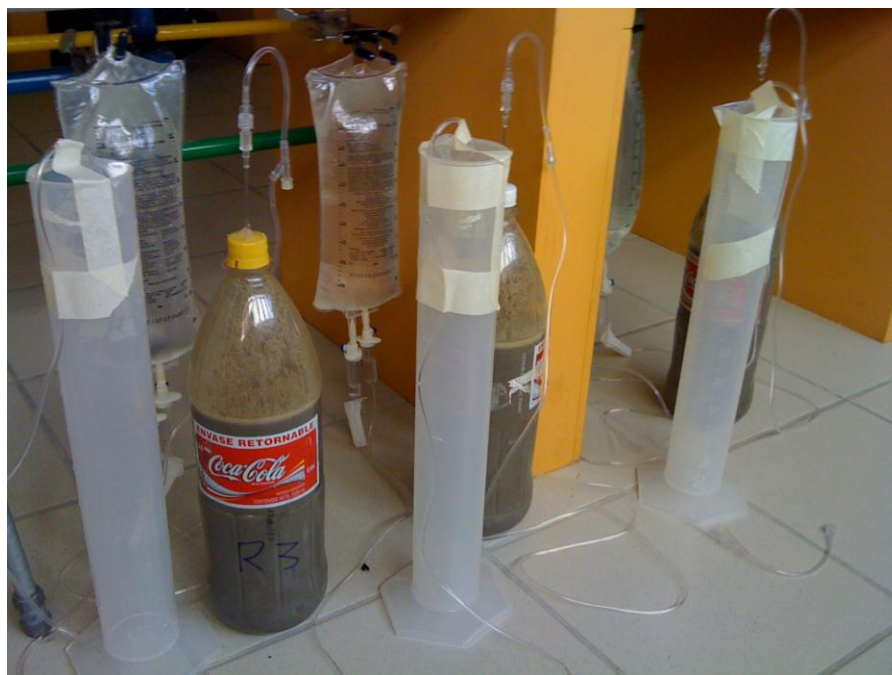
Fotografía 5-6. Reactores durante los ensayos de actividad metanogénica.
