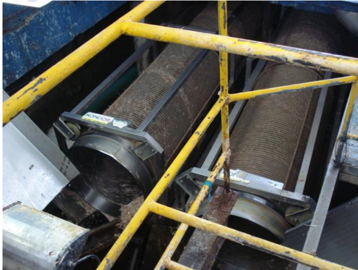
Fotografía 2-2. Filtros de tambor rotatorios para separación de plumas.
