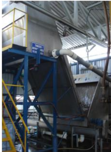
Fotografía 2-3. Sistema de filtros tamiz en serie.
