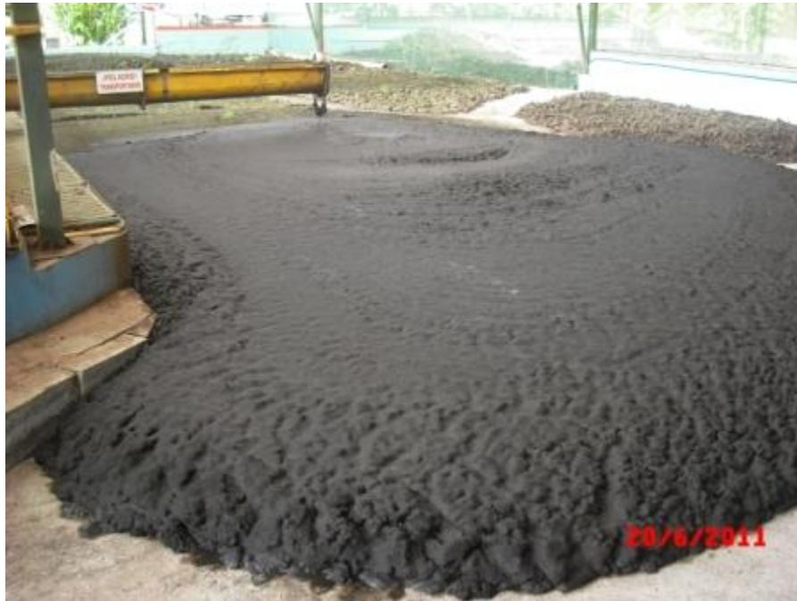
Fotografía 5-5. Lodo anaerobio estabilizado luego del filtro lento.
