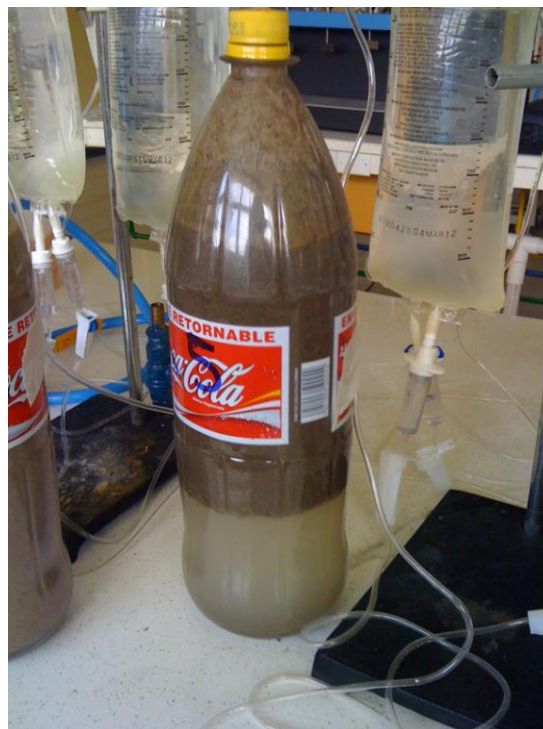
Fotografía 5-8. Acumulación del lodo en la zona superior del reactor R5.
