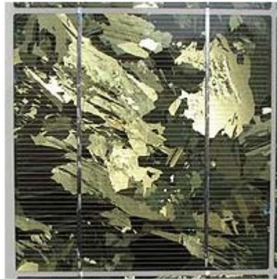
Figura 3.5. Célula de silicio policristalino [8]
