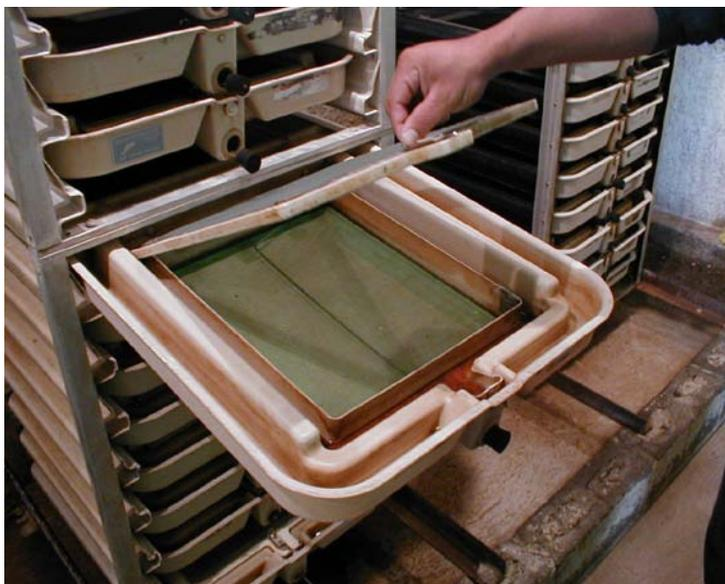
Foto 31. Gavetas o bandejas de las incubadoras de flujo vertical. Ver interior de la bandeja donde se depositan los huevos fertilizados.
