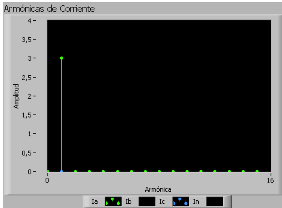
Figura 6.3 Magnitud de los primeros 15 armónicos para la señal presentada en la figura 6.2
