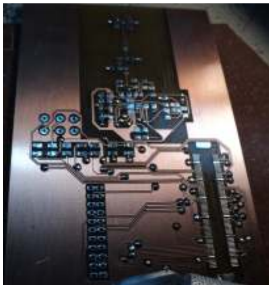
Figura 5.8 Placa de RF para acoplar el CC1101 al PICkit.
