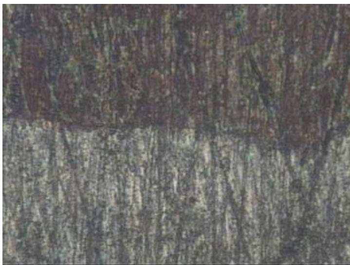
Figura 4.10: Sustrato de acero A36 después de prueba electroquímica en ácido Sulfúrico, ampliación a 200x.
