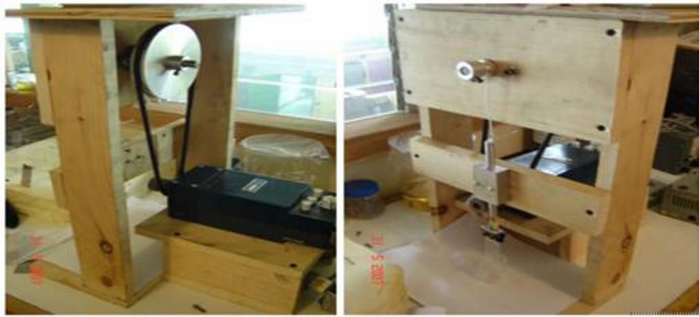
Figura 3.1: Mecanismo para la técnica inmersión-extracción con Motor 1.
