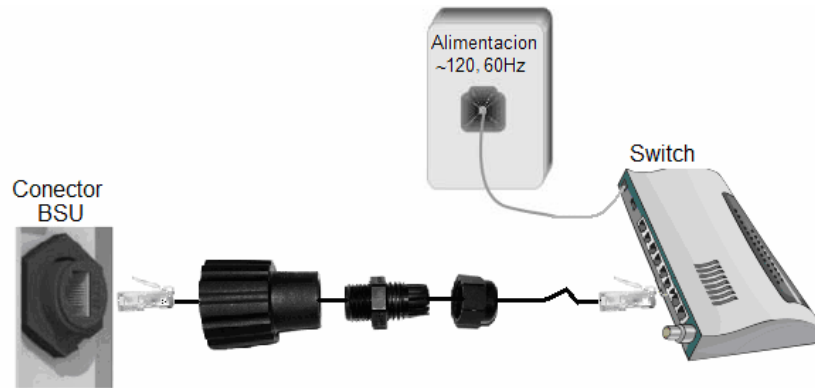
Figura A.3 Conexión entre BSU y switch, sin alimentador POE externo
