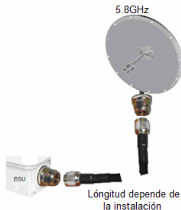
Figura A.8 Conexión de una antena a la BSU, sin protector de descargas.
