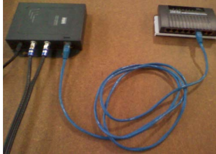
Figura 5.17. Conexión de cable UTP categoría 5 entre Inyector de corriente y el switch.
