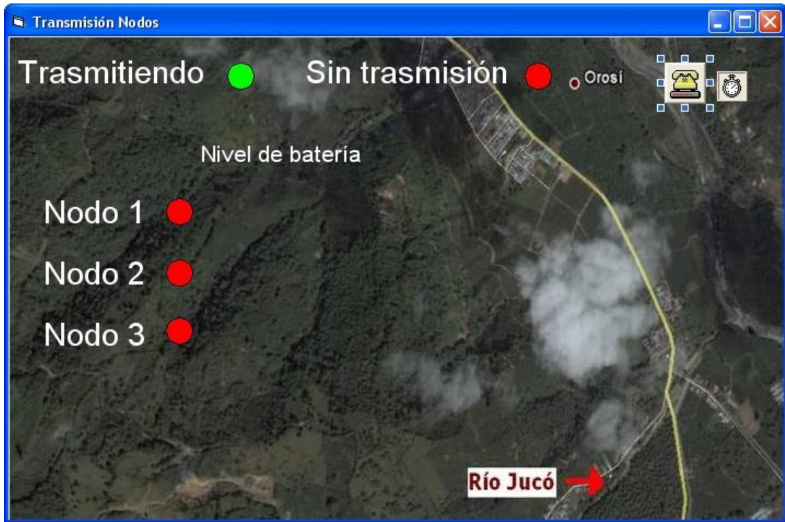
Figura 5.8 Formulario conexión mostrando la transmisión de los nodos y su respectivo nivel de batería
