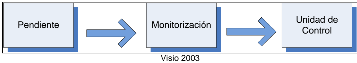
Figura 3.1 Sistema de alarma contra deslizamientos
