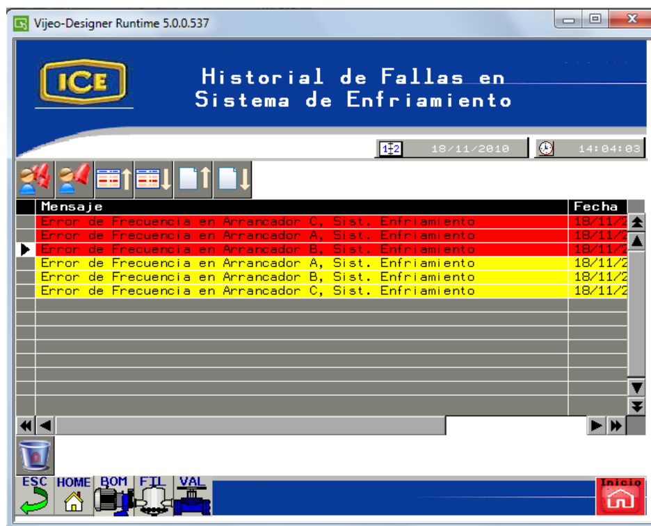
Figura 25. Resumen de últimos fallos en el sistema de Enfriamiento
