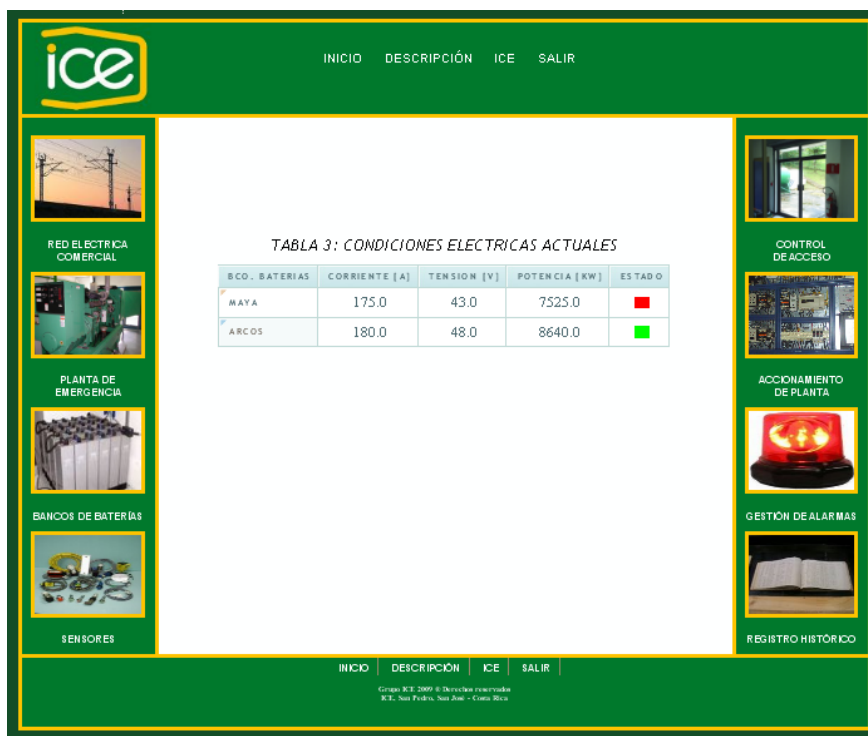
Figura A.2.5.2 Vista del monitoreo de los parámetros eléctricos de los bancos de baterías Maya y Arcos.
