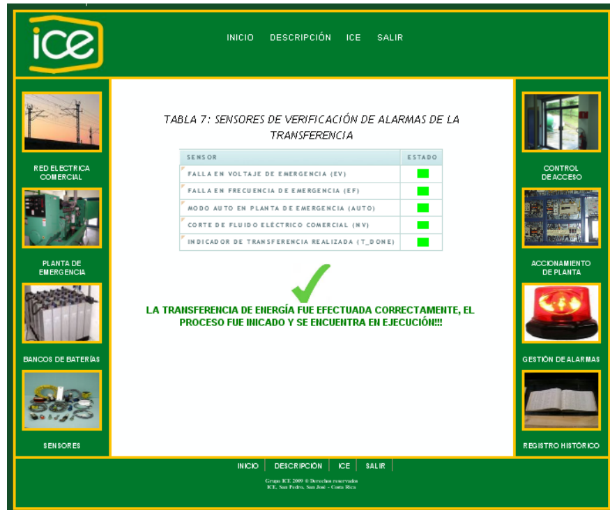
Figura A.2.6.3.4 Vista de verificación para el proceso de arranque de planta y transferencia.
