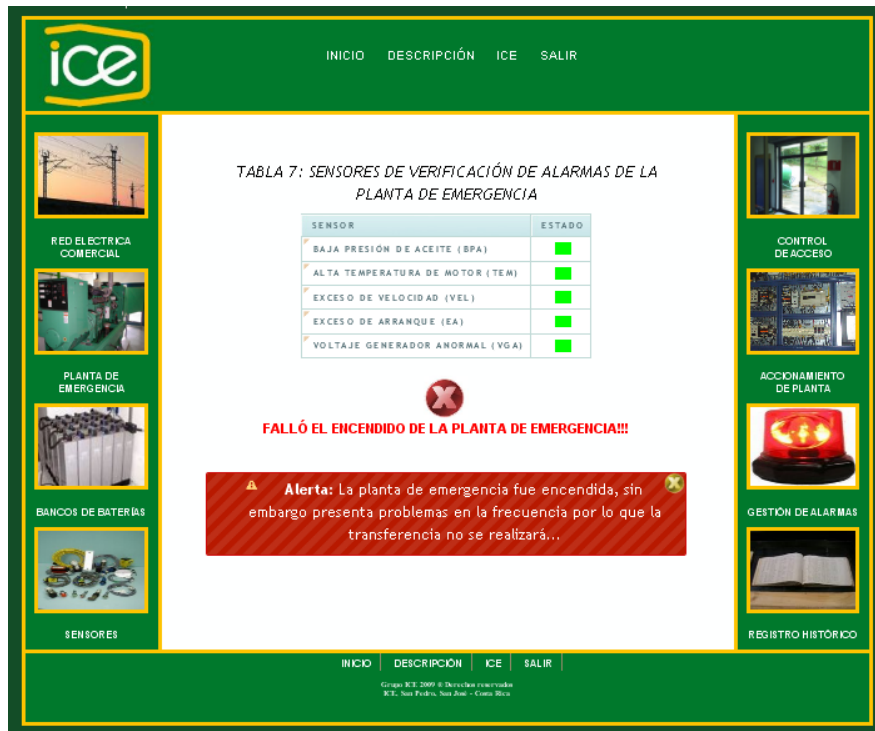
Figura A.2.6.3.5 Vista que indica que pese a que la planta arrancó, la transferencia no se realizó debido a un problema de frecuencia en la planta.
