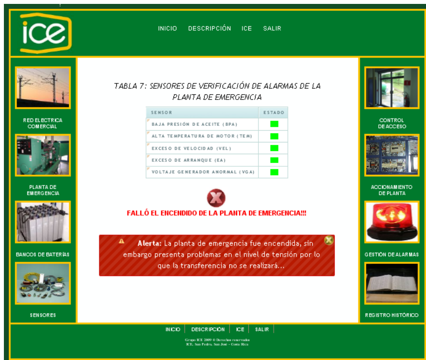
Figura A.2.6.3.6 Vista que indica que pese a que la planta arrancó, la transferencia no se realizó debido a un problema de nivel de tensión en la planta.
