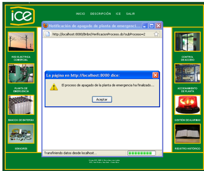
Figura A.2.6.4.4 Notificación al usuario de que el proceso de retransferencia y apagado de planta fue finalizado.
