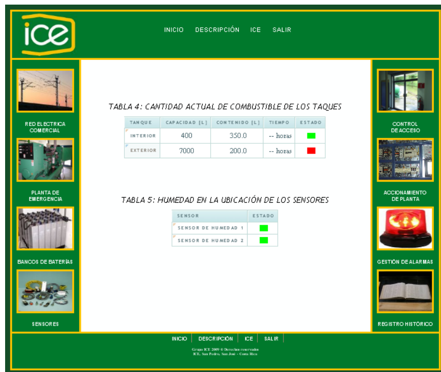
Figura A.2.5.3 Vista del monitoreo de los sensores de humedad y del nivel de combustible de los tanques de combustible.
