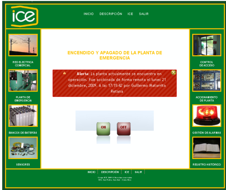
Figura A.2.6.1.1 Vista que alerta al usuario remoto que la planta se encuentra encendida.
