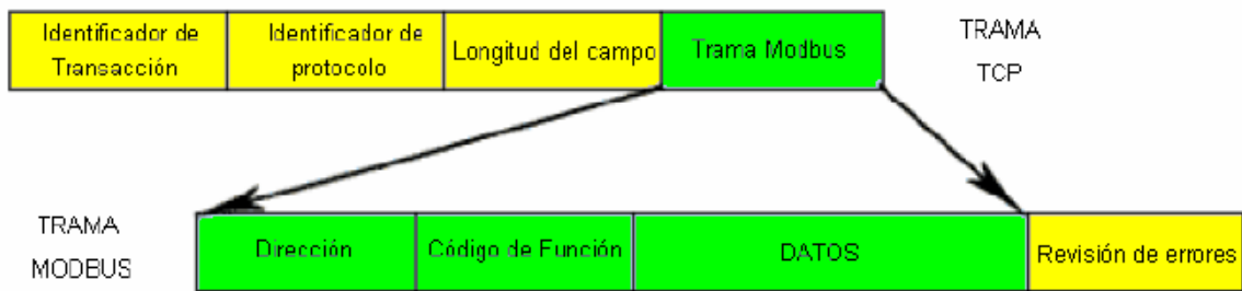
Figura 3.2.5.2.1 Encapsulado de un mensaje modbus en una trama TCP.
