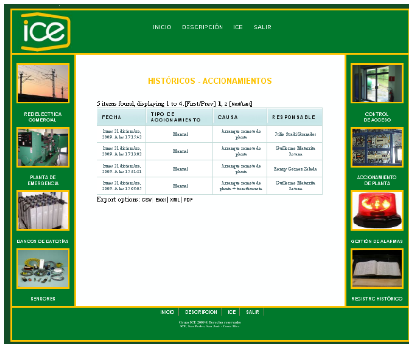
Figura A.2.8.3 Vista que muestra un ejemplo de la presentación de registros históricos, en este caso los registros que se tienen de los accionamientos de planta.
