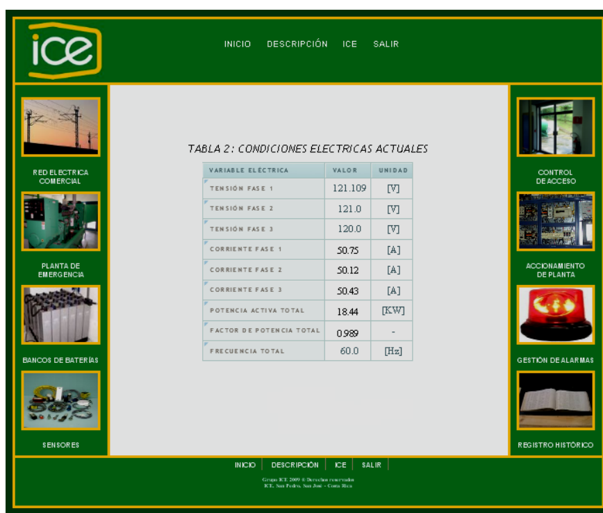
Figura A.2.5.1 Vista del monitoreo de los parámetros eléctricos de la planta eléctrica.
