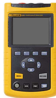
Figura 1. Medidor de calidad de energía FLUKE 43B.
