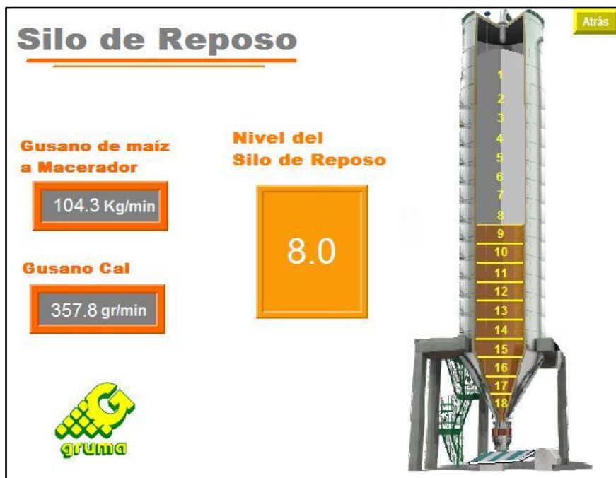
Figura 5.15 Pantalla principal de monitoreo del silo de reposo
