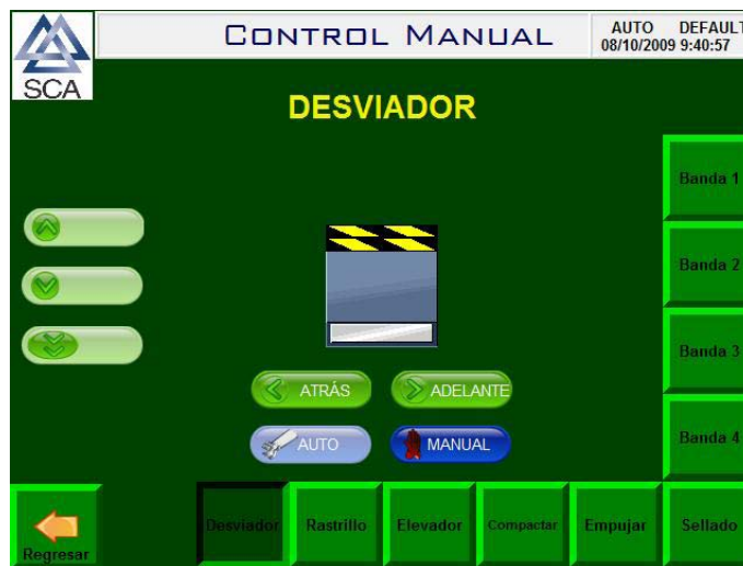
Figura 6.4. Control manual del desviador.
