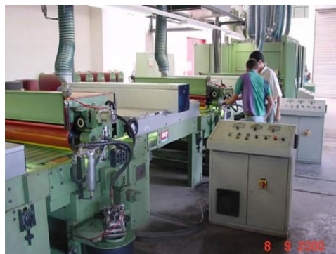
Figura 18. Proceso de laqueado para la elaboración de piso de teca ( Tectona grandis ), Panamerican Woods S.A., Nandayure, Guanacaste. 2001.
