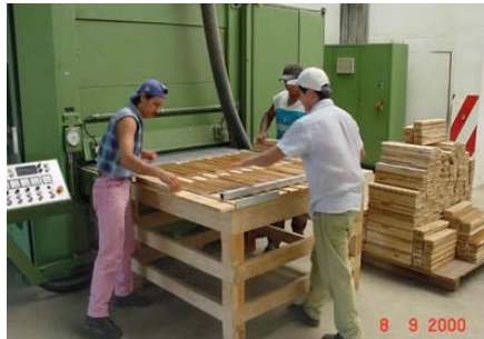
Figura 15. Proceso de lijado de madera para la elaboración de piso de teca ( Tectona grandis ), Panamerican Woods S.A., Nandayure, Guanacaste. 2001.
