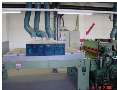
Figura 19. Proceso de curado ultravioleta para la elaboración de piso de teca ( Tectona grandis ), Panamerican Woods S.A., Nandayure, Guanacaste. 2001.
