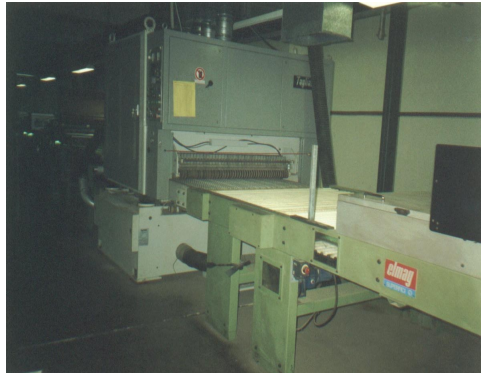
Figura 17. Proceso de lijado después del sellado de madera para la elaboración de piso de teca ( Tectona grandis ), Panamerican Woods S.A., Nandayure, Guanacaste. 2001.
