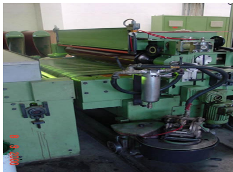
Figura 16. Proceso de aplicación de selladores para la elaboración de piso de teca ( Tectona grandis ), Panamerican Woods S.A., Nandayure, Guanacaste. 2001.
