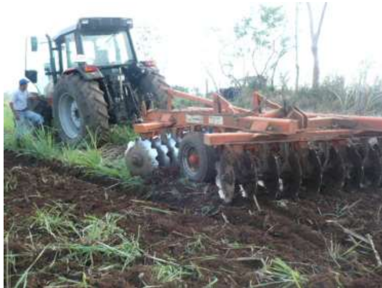
Figura 11. Rastra rompedora utilizada en preparación para el cultivo de piña (20 discos de 26”), Pocosol de San Carlos, Costa Rica (Vargas K, 2008).
