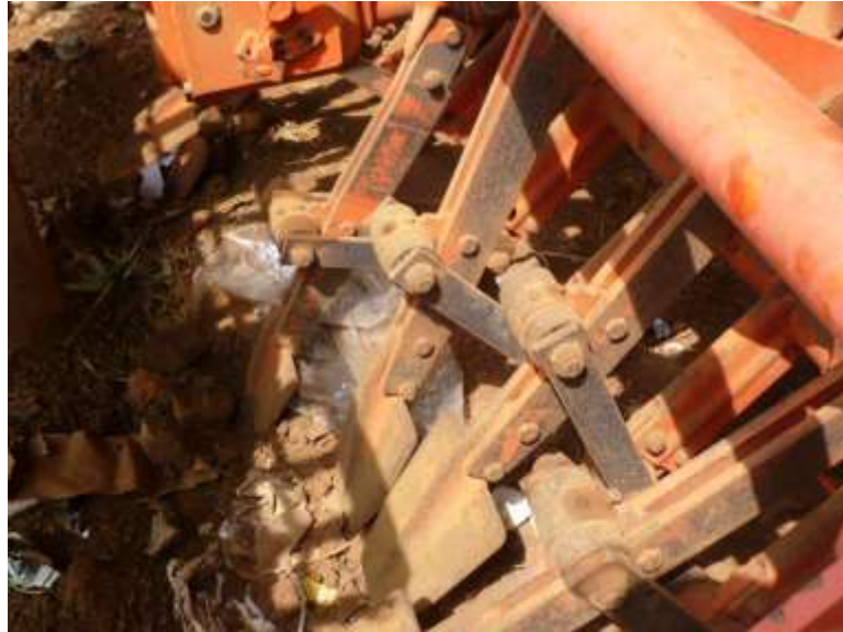
Figura 15. Paletas o palínes que son las piezas que penetran en el suelo haciendo la labor de pulverizado del suelo. Pocosol San Carlos (Vargas K, 2008).
