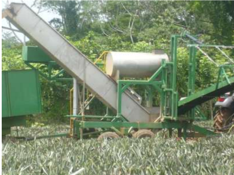
Figura 21. Tratadora de semilla de piña que se utiliza en el campo. Pocosol San Carlos (Vargas K, 2008).
