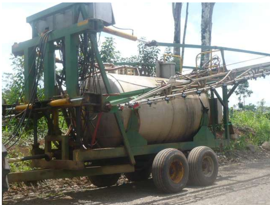
Figura 19. Equipo de aspersión para el cultivo de piña. Pocosol San Carlos (Vargas K, 2008).
