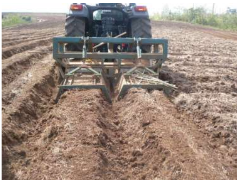
Figura 25. Utilización de encamadora de dos cuerpos en preparación de suelo para el cultivo de piña, Pocosol, San Carlos, Costa Rica (Vargas K, 2008).
