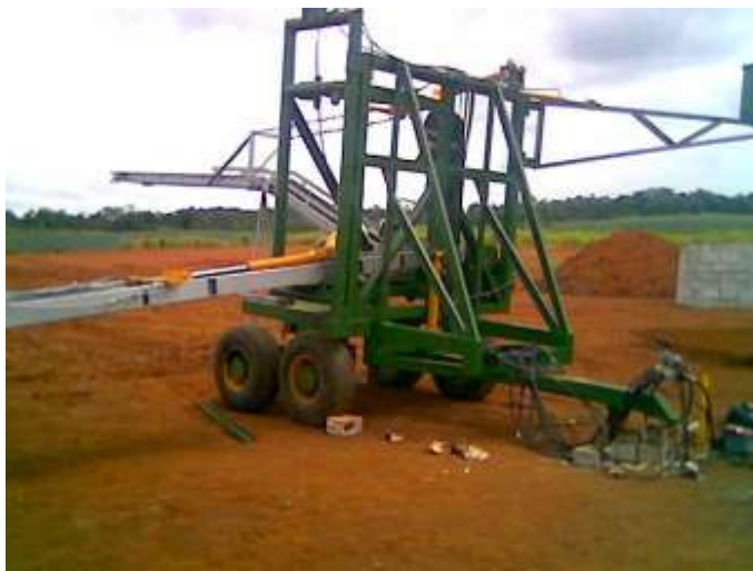
Figura 20. Cosechadora de fruta de tiro utilizada para el cultivo de piña. Pocosol San Carlos (Vargas K, 2006).
