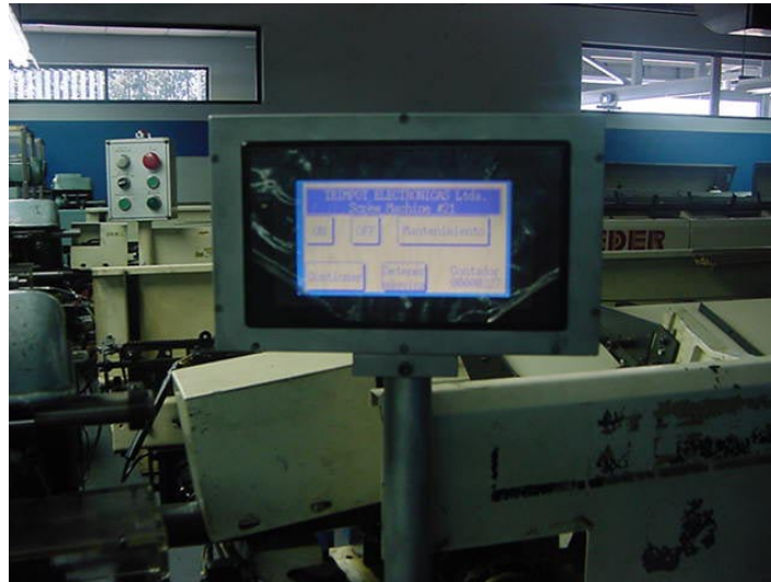
Figura 6.2 Pantalla de tacto que reemplazó la botonera original.
