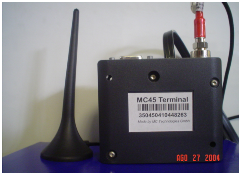
Figura 3.5 Fotografía del Módem MC45 Terminal usado para el diseño del prototipo [14]
