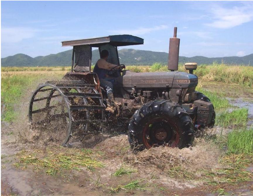
Figura 6. Tractor fangueando en lote arrocero. Finca en Bagaces, Gte.
