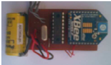
Figura 5.6 Circuito impreso y componentes colocados.
