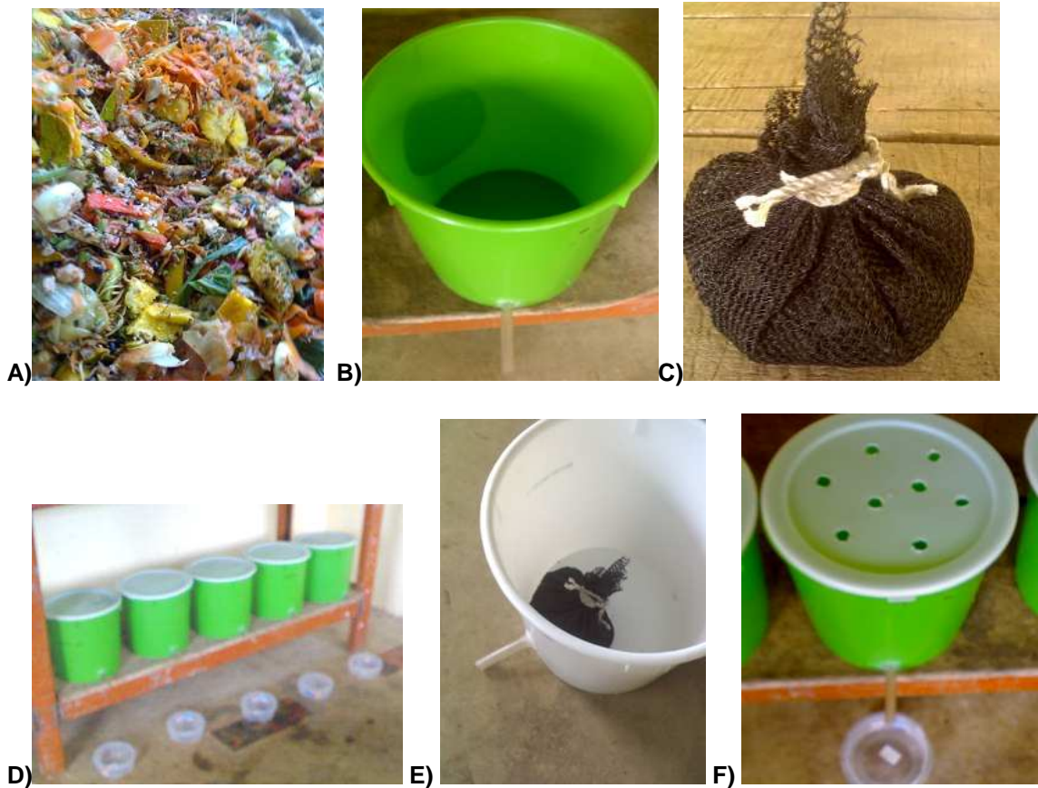
Figura 7. Proceso de montaje de los tratamientos. A) Desechos de cocina mezclados y cortados. B) Balde adaptado con una manguerilla para expulsión de lixiviados. C) Filtro de carbón envuelto en sarán. D) Balde con filtro colocado en la manguerilla. E) Tapa agujereada para las condiciones aeróbicas de la mitad de los tratamientos. F) Cinco tratamientos en anaerobiosis (tapas sin agujeros).
