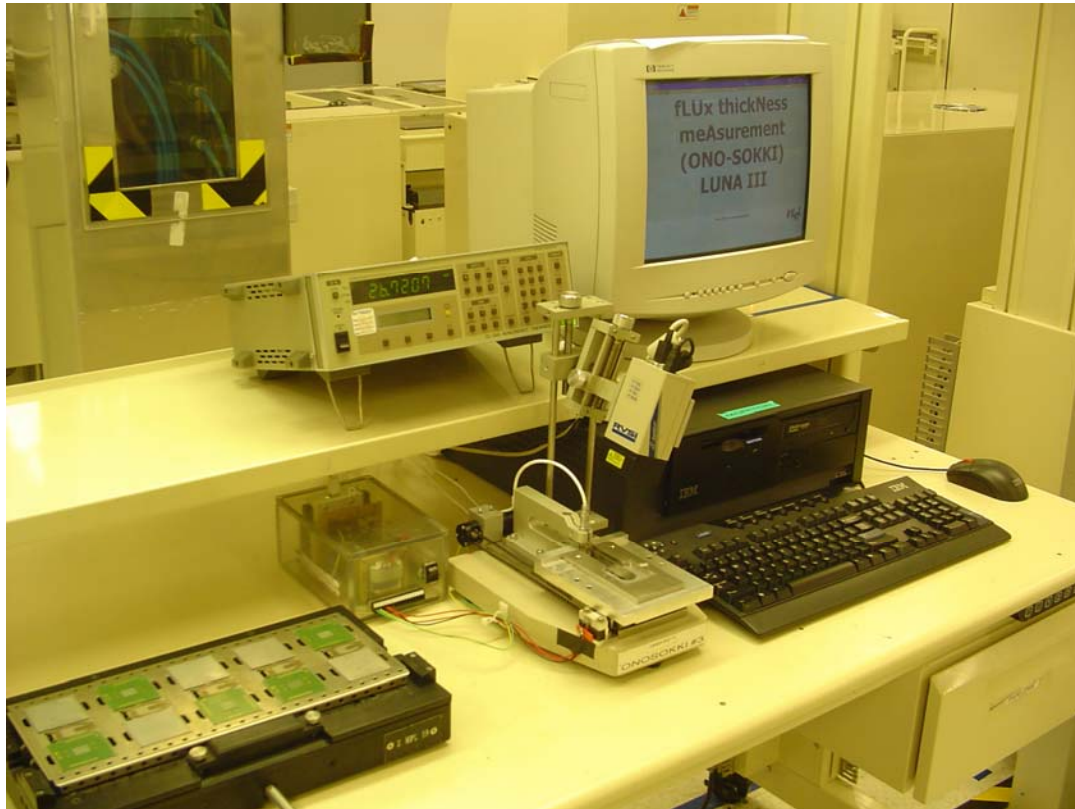
Figura 6.2.1 Foto del Sistema completo para le monitoreo de espesor de flux de forma más automatizada.
