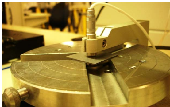
Figura B.1.5 Posición correcta del cupón para realizar la medición.
