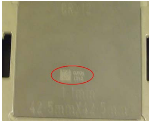
Figura 6.2.5 Matriz de puntos impresa con láser sobre el cupón metálico para su identificación.
