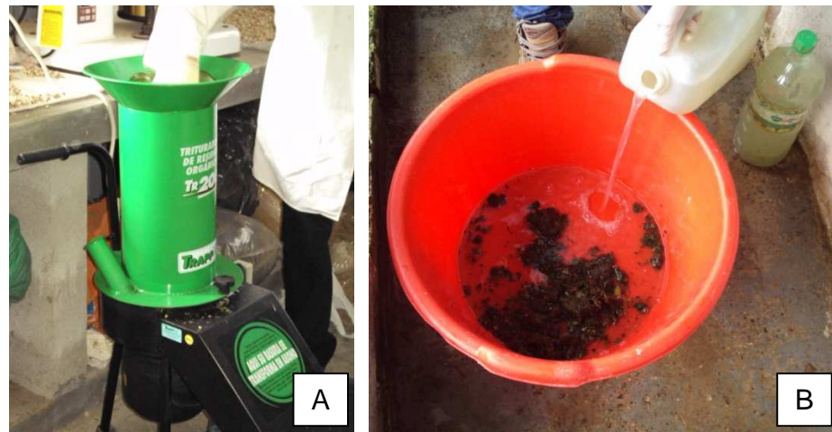
Figura 2. A. Triturador de residuos orgánicos utilizado. B. Mezcla de los lirios triturados con el agua residual.
