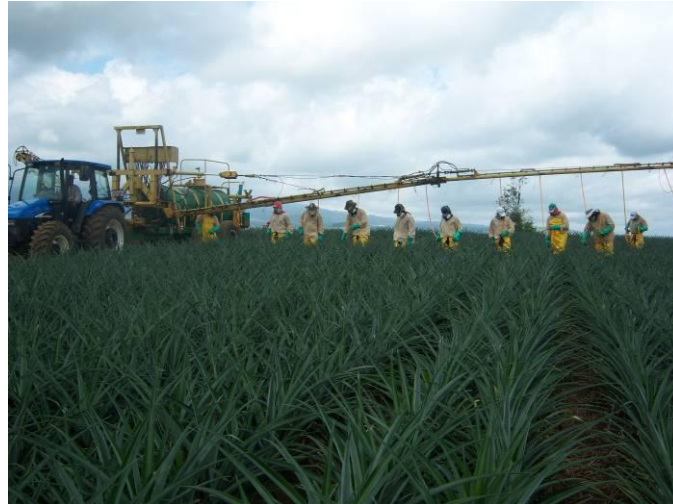
Figura 1. Labor de aplicación por el método de Stroller o aplicación dirigida. Finca El Tremedal S.A. Venecia de San Carlos. 2009.
