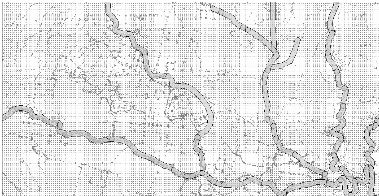
Figura 8. Nube de puntos generada por ERDAS-LPS para la hoja cartográfica Tejar a partir de las imágenes satelitales VW-2. Los puntos marcan posiciones X,Y,Z mientras que los polígonos marcan lo que se considera la red de drenaje del área adyacente.
