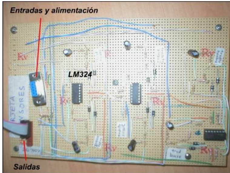
Figura 5-12 Construcción de la Tarjeta de sensores en placa universal
