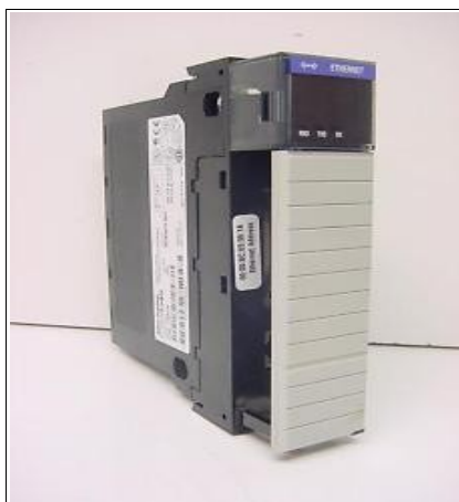
Figura 5.2.2 Módulo de comunicación EtherNet/IP 1756-ENET/B [22]
