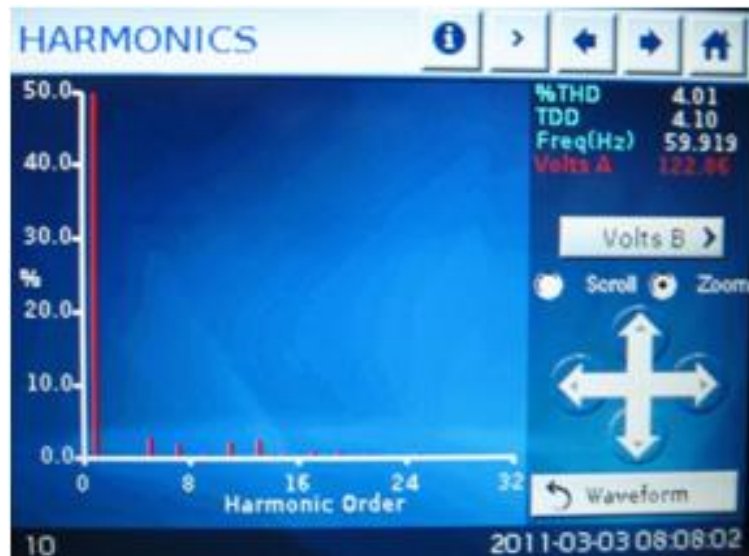
Figura A.4.1 Espectro de armónicos de la fase A utilizando el analizador de calidad de energía Nexus 1500.
