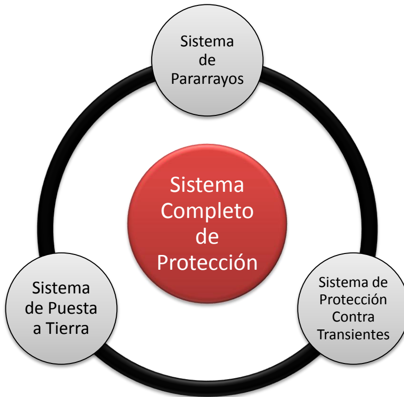
Figura 3.1 Sistema completo de protección contra distorsiones en la red de distribución eléctrica.
