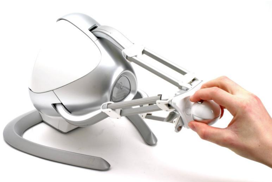
Figura B.1.1. Forma correcta de manipular la interfaz háptica.
