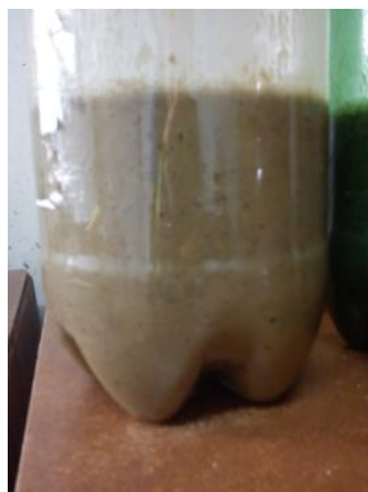
P2: Muestra de agua con mucílago tomada del tanque pulmón. Una hora después de agregarse los 5g de levadura.
