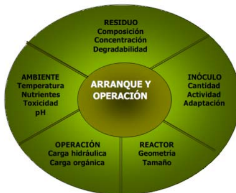
Figura 3 Condiciones que afectan un reactor anaerobio durante su arranque y operación. Fuente: (Rodríguez)
