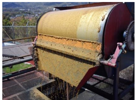
Tamiz rotatorio en funcionamiento. Obsérvese la cantidad de agua que sale junto con el sólido.
