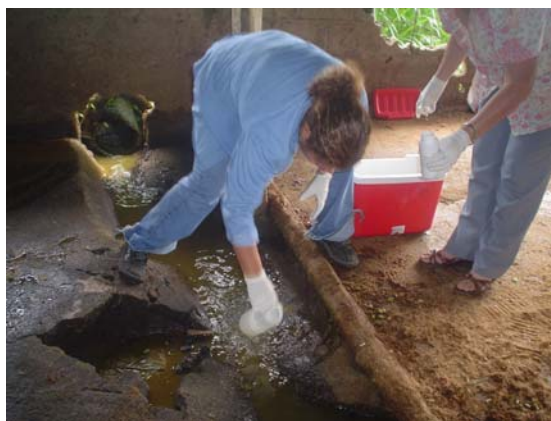
Toma de muestras para los análisis químicos del agua residual.
