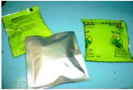
Fotografía 19. Tercer y cuarto tipo de material de empaque: laminado doble (verde) y laminado triple (plateado)
