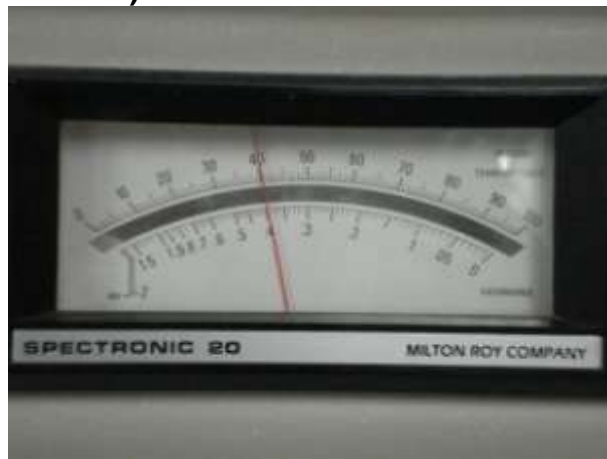
Fotografía 9. a) Refractómetro Atago, modelo N-50E Brix 0-50%. b) Medición de grado Brix de una muestra. c) Porcentaje de transmitancia determinado con el espectrofotómetro Spectronic 20
