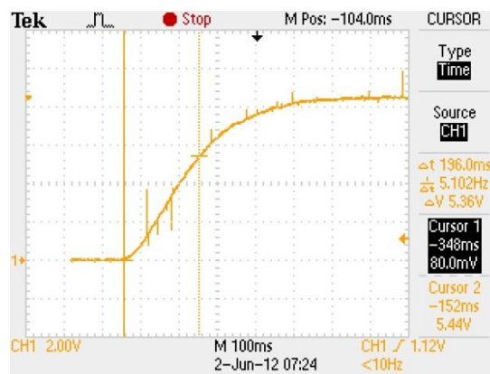
Figura 21. Curva de velocidad del Motor CD y Gearbox.
