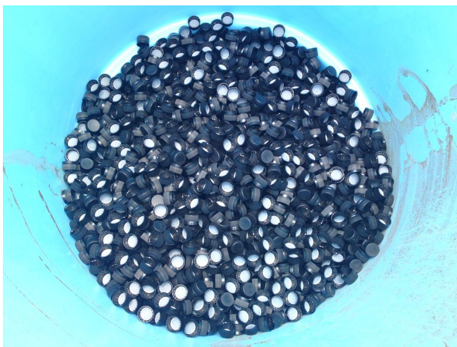
Figura 6. FAFA 2. Medio filtrante: Tapas Plásticas.
