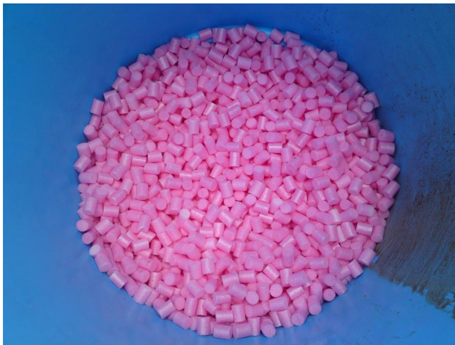
Figura 7. FAFA 3. Medio filtrante: Cilindros de Espuma.
