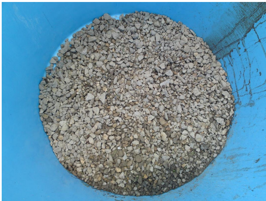
Figura 5. FAFA 1. Medio filtrante: Piedra.
