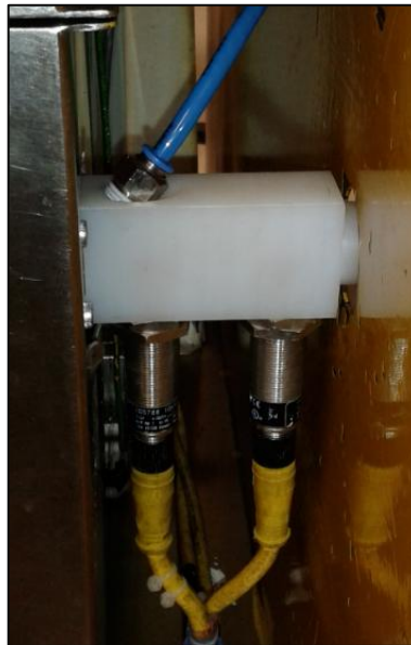
Figura 3.15. Sensores inductivos IFM IG5788 antes del ingreso a la guillotina
