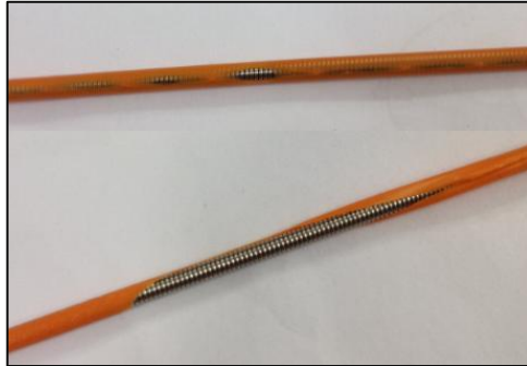
Figura 1.4. Recubrimiento de polietileno no homogéneo en los coils .
