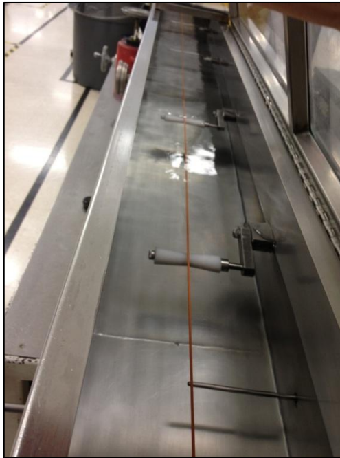
Figura 3.12. Módulo tanque de enfriamiento
