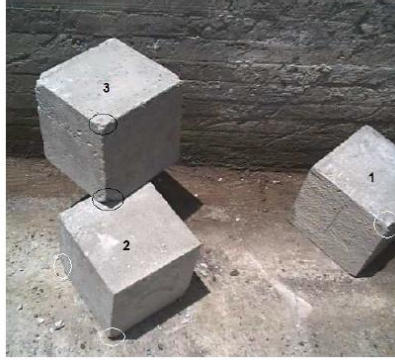
Figura 5. Técnica de macro encapsulación de pilas en bloques de cemento.
