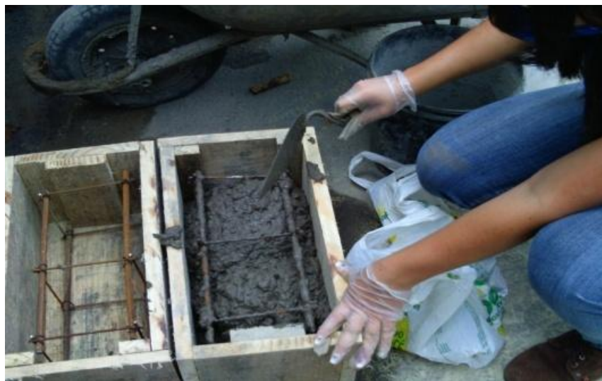
Figura 19. Macroencapsulamiento de baterías no identificables en la CTRB.
