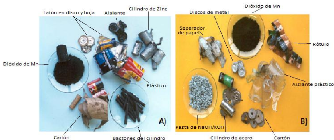
Figura 18. Componentes de las pilas Zinc-Carbono (A) y Alcalinas de Mn (B). Fuente: Wolff, 2001 (23)
