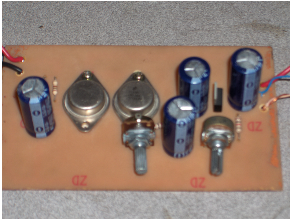
Figura 4. 9 Convertidor cd-cd de 24V/12V y de 12V/5V.
