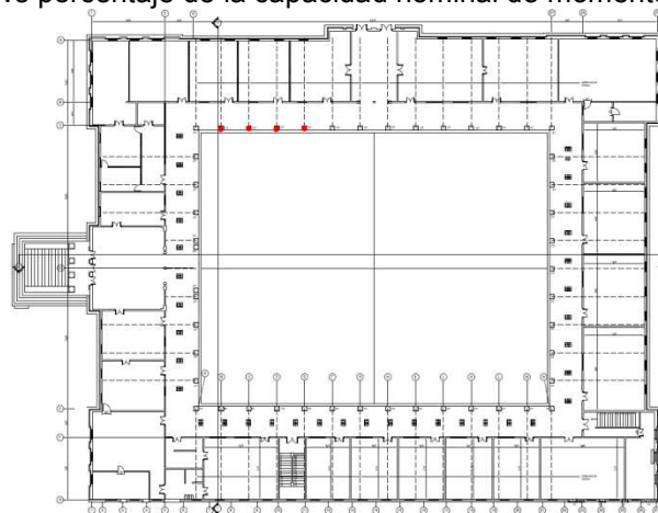
Figura 74. Ubicación de columnas críticas
