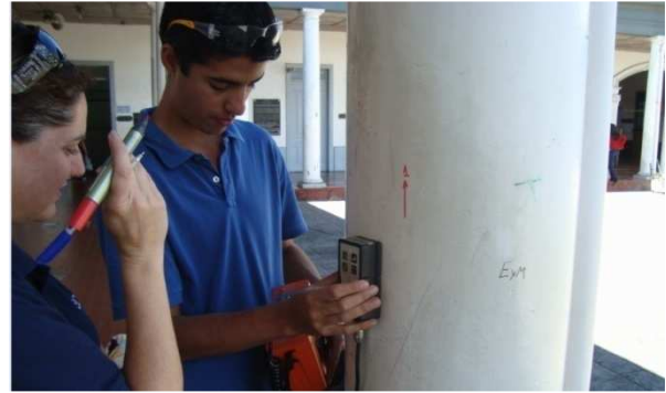
Figura 16. Detección de acero en columna circular (C7).
