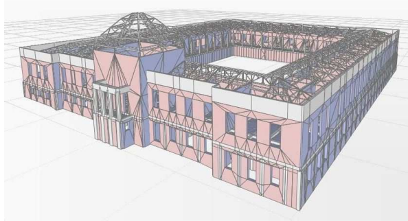
Figura 30. Vista 3D del modelo del edificio central del colegio San Luis Gonzaga
