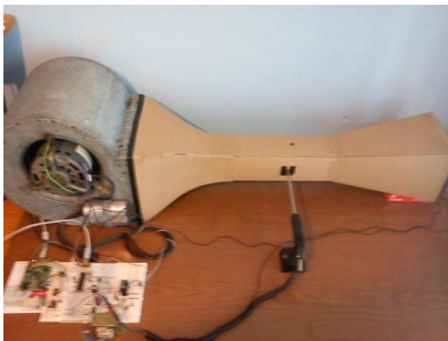
Figura 3.14. Implementación túnel de viento de baja velocidad para mediciones de ruido Inducido sobre micrófonos
