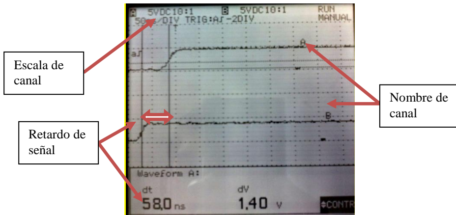
Figura 6.1 Diagrama datos en la imagen del osciloscopio.
