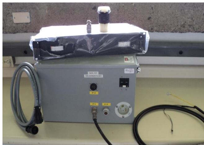
Figura 5.14. Fuente CD de alta tensión y su controlador.
