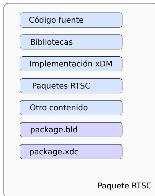
Figura 2.10: Contenido de un paquete RTSC
