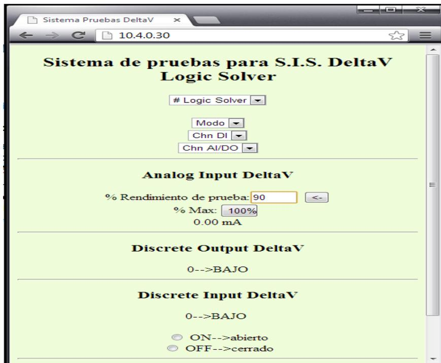
**Figura 24.** Interfaz de usuario ejecutada en el navegador web.
