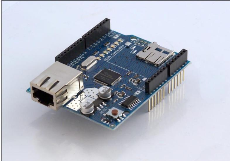
**Figura 8.** Escudo Ethernet Arduino.
