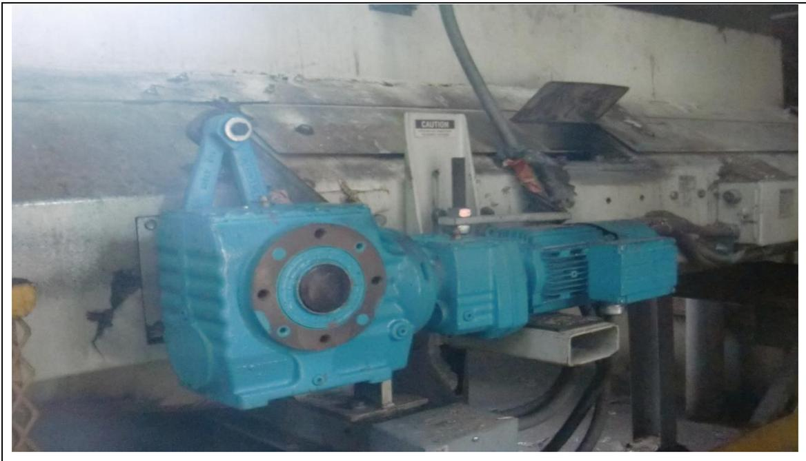
**Figura 6.11** Servomotor de accionamiento de la cinta.
