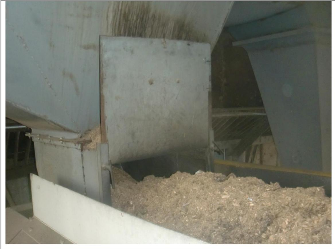
**Figura 6.10** Boquilla de salida Tolva báscula de cascarilla de arroz.
